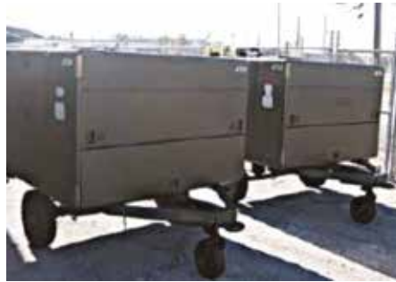
שימור חלפים תעופתיים כנגד קורוזיה כשהם סגורים עם אינהיביטורים - כפי שמיישם חיל האוויר האמריקני
