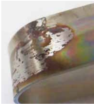
תוצאות הניסוי: בלוחיות פלב"מ בטבילה חלקית במי ים ללא אינהיביטור התפתחה סדיקת מאמצים בתוך 21 יום
